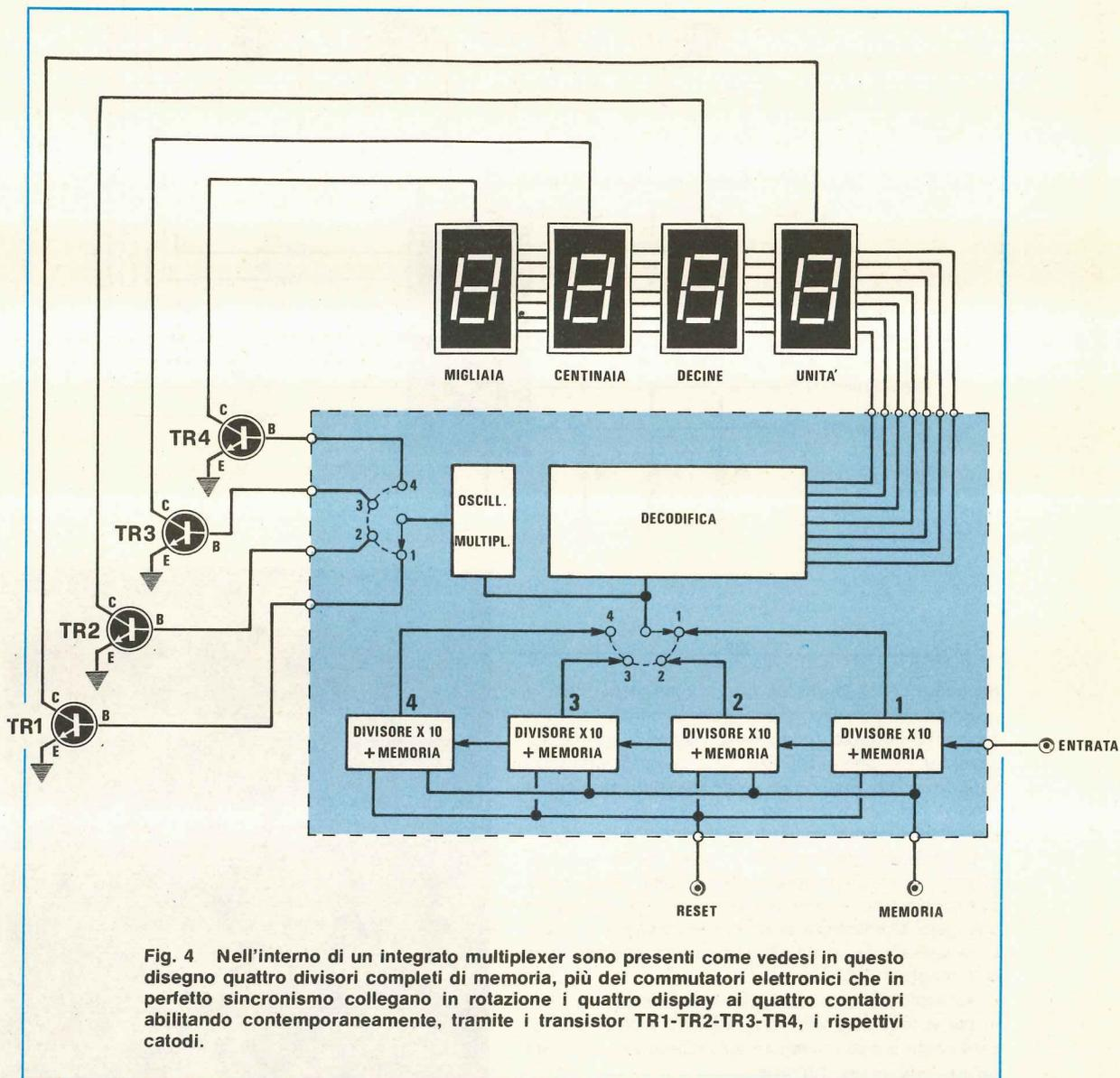
Fig. 4 Nell'interno di un integrato multiplexer sono presenti come vedesi in questo disegno quattro divisori completi di memoria, più dei commutatori elettronici che in perfetto sincronismo collegano in rotazione i quattro display ai quattro contatori abilitando contemporaneamente, tramite i transistor TR1-TR2-TR3-TR4, i rispettivi catodi.
