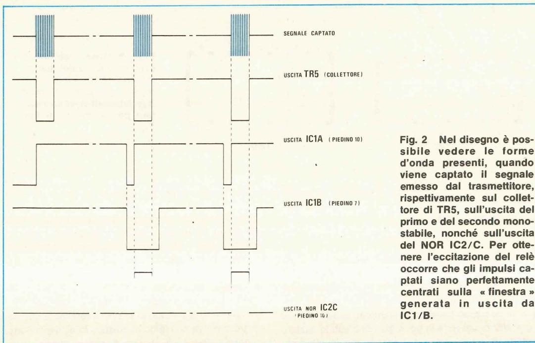
**Fig. 2** Nel disegno è possibile vedere le forme d'onda presenti, quando viene captato il segnale emesso dal trasmettitore, rispettivamente sul collettore di TR5, sull'uscita del primo e del secondo monostabile, nonché sull'uscita del NOR IC2/C. Per ottenere l'eccitazione del relè occorre che gli impulsi captati siano perfettamente centrati sulla « finestra » generata in uscita da IC1/B.
