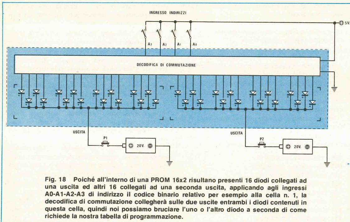
**Fig. 18** Poiché all'interno di una PROM 16x2 risultano presenti 16 diodi collegati ad una uscita ed altri 16 collegati ad una seconda uscita, applicando agli ingressi A0-A1-A2-A3 di indirizzo il codice binario relativo per esempio alla cella n. 1, la decodifica di commutazione collegherà sulle due uscite entrambi i diodi contenuti in questa cella, quindi noi possiamo bruciare l'uno o l'altro diodo a seconda di come richiede la nostra tabella di programmazione.
