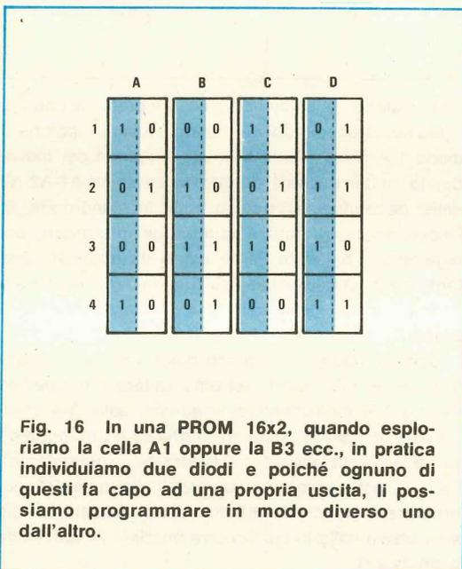
Fig. 16 In una PROM 16x2, quando esploriamo la cella A1 oppure la B3 ecc., in pratica individuiamo due diodi e poiché ognuno di questi fa capo ad una propria uscita, li possiamo programmare in modo diverso uno dall'altro.
