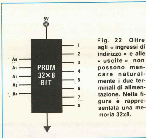
Fig. 22 Oltre agli « ingressi di indirizzo » e alle « uscite » non possono mancare naturalmente i due terminali di alimentazione. Nella figura è rappresentata una memoria 32x8.
