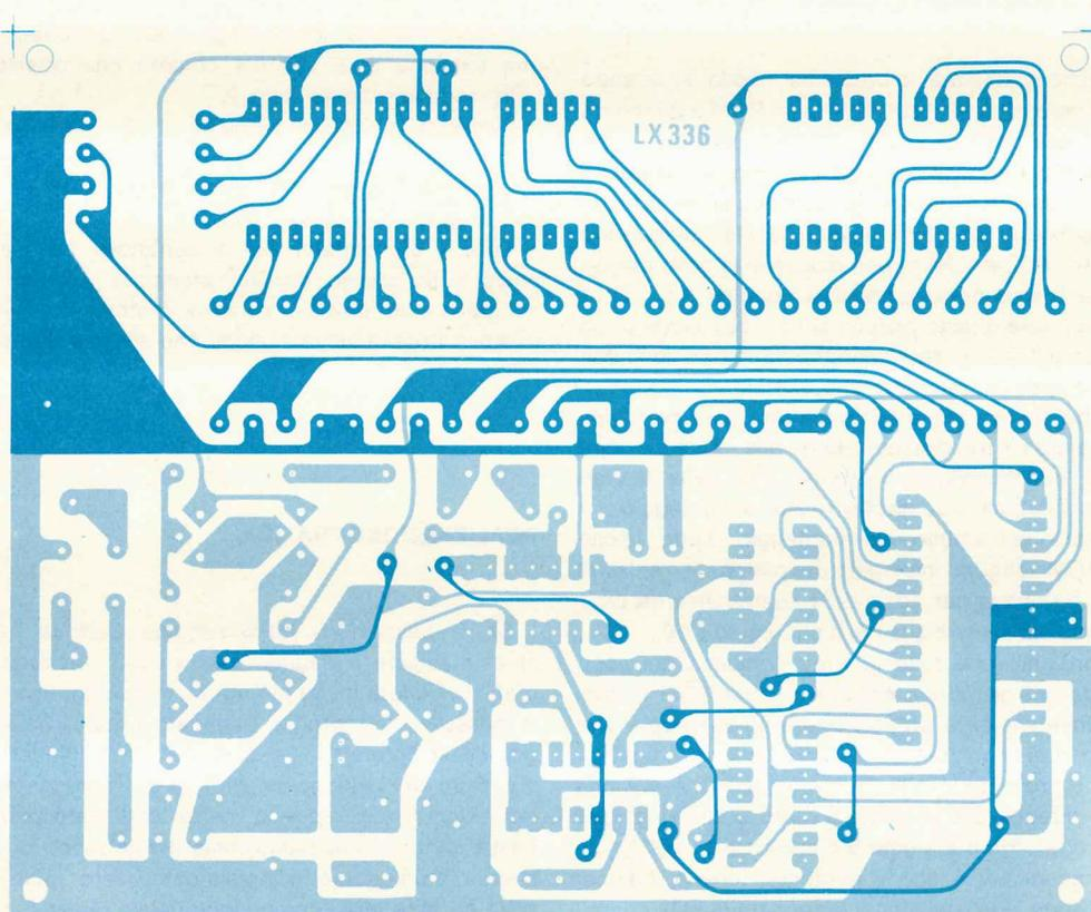
**Fig. 8** Circuito stampato a grandezza naturale necessario per realizzare la nostra slot-machine. Tale circuito risulta a doppia faccia pertanto prima di montare su di esso qualsiasi componente dovremo preoccuparci di effettuare tutti i ponticelli di collegamento fra le piste superiori e quelle inferiori.
