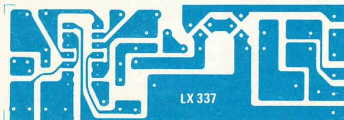
Fig. 4 a sinistra. Circuito stampato a grandezza naturale necessario per ricevere i componenti del trasmettitore.
