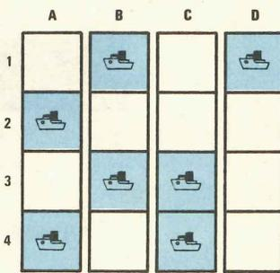
Fig. 8 Una ROM si può paragonare ad una tabella formata da tanti quadretti (ogni quadretto è una cella di memoria) in ognuno dei quali possiamo programmare un « 1 » (presenza di nave) oppure uno « 0 » (assenza di nave). Fornendo le coordinate A-1 A-2 B-1 ecc., noi possiamo quindi esplorare le diverse caselle e stabilire quale condizione logica è presente in ciascuna di esse.
