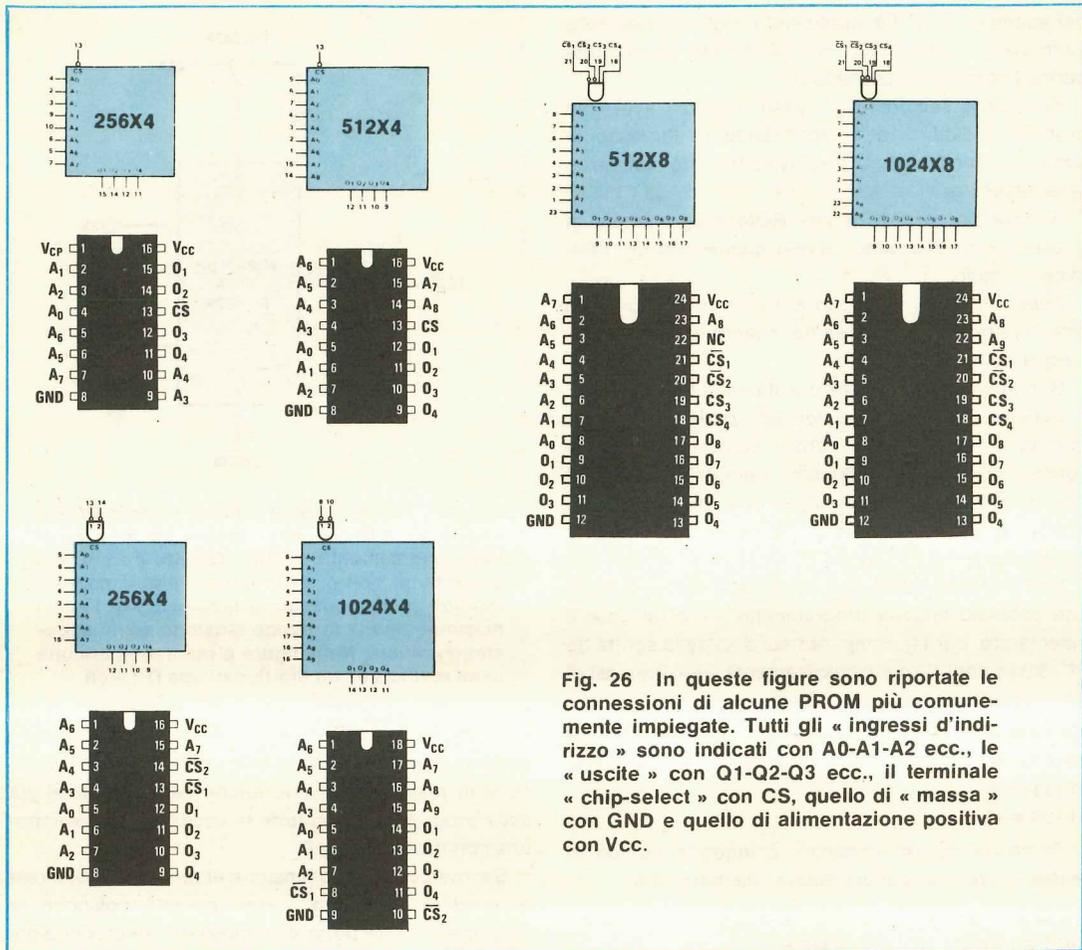
Fig. 26 In queste figure sono riportate le connessioni di alcune PROM più comunemente impiegate. Tutti gli « ingressi d'indirizzo » sono indicati con A<sub>0</sub>-A<sub>1</sub>-A<sub>2</sub> ecc., le « uscite » con Q<sub>1</sub>-Q<sub>2</sub>-Q<sub>3</sub> ecc., il terminale « chip-select » con CS, quello di « massa » con GND e quello di alimentazione positiva con V<sub>cc</sub>.
