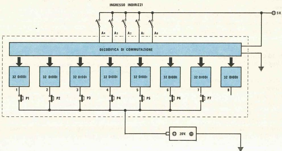
Fig. 24 Teoricamente, per « bruciare » i diodi contenuti nelle 7 celle (la 8° cella rimane inutilizzata) sarebbe sufficiente applicare sulle uscite dei pulsanti pigiando solo quelli relativi alle celle interessate. In pratica, come già accennato nell'articolo, per bruciare i diodi, occorre un apposito circuito in grado di fornire degli impulsi della durata di circa 200 microsecondi diversamente ricorre il rischio di danneggiare la PROM.
