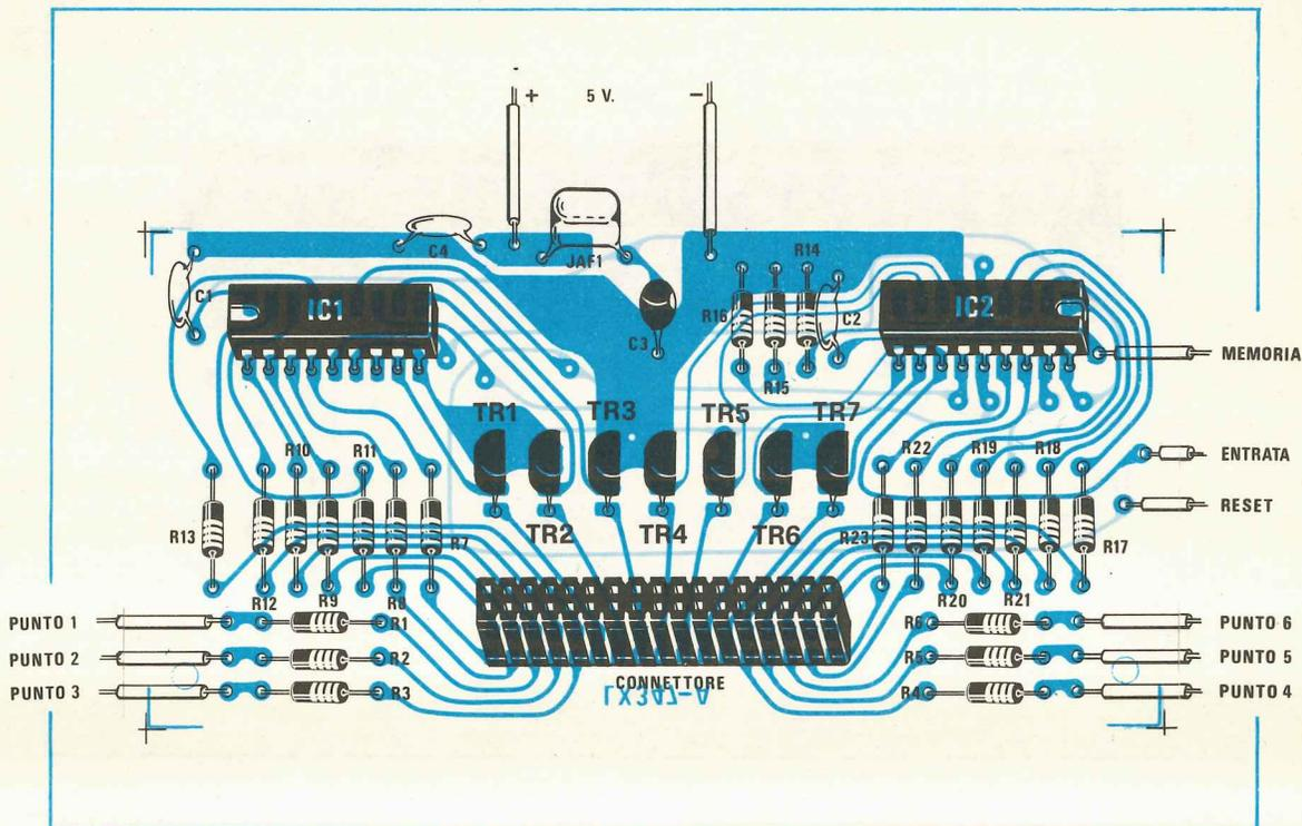
Fig. 14 Schema pratico di montaggio del telaio di conteggio multiplexer per sette display. Questo circuito porta la sigla LX.347.A.
