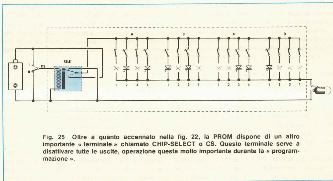
Fig. 25 Oltre a quanto accennato nella fig. 22, la PROM dispone di un altro importante « terminale » chiamato CHIP-SELECT o CS. Questo terminale serve a disattivare tutte le uscite, operazione questa molto importante durante la « programmazione ».
