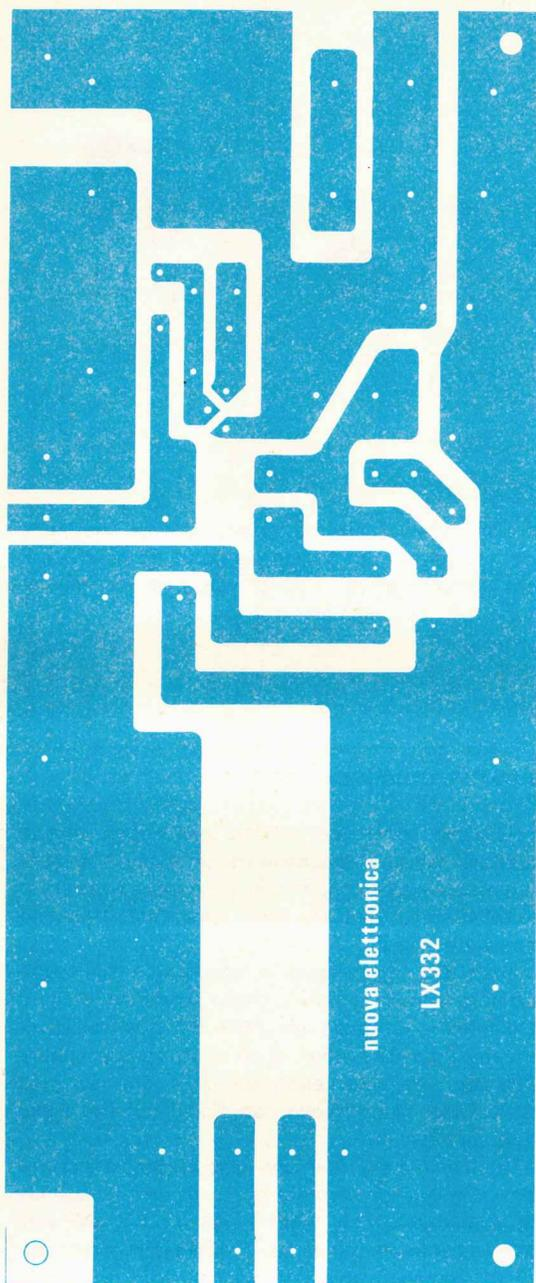
**Fig. 3** Disegno a grandezza naturale del circuito stampato in fibra di vetro necessario per la realizzazione di questo alimentatore stabilizzato.
