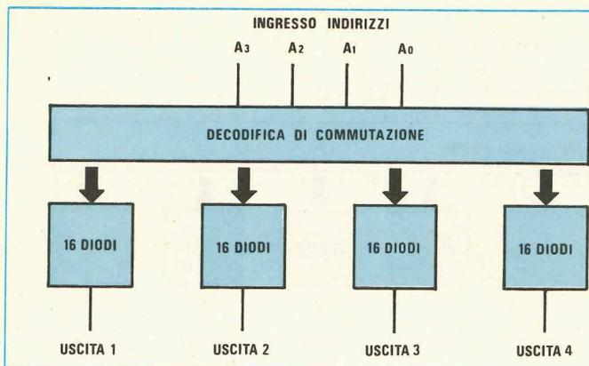
Fig. 20 Una PROM 16x4 la possiamo raffigurare come quattro « blocchi » contenenti ciascuno 16 diodi collegati ognuno ad una propria uscita. Quando sugli ingressi A0-A3 di indirizzo applichiamo un codice binario per esplorare ad esempio la casella B4, sulla uscita 1 risulta collegato il diodo B4 della prima cella, sull'uscita 2 il diodo B4 della seconda cella e così pure sulla 3° e 4° uscita.
