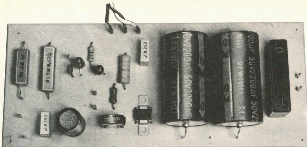
Un alimentatore stabilizzato per laboratorio con tensione d'uscita regolabile, provvisto di protezione in corrente su 4 diverse portate e di indicatore visivo di sovraccarico, che può erogare 3 ampère massimi ma che con pochissime modifiche può essere predisposto per erogare fino a 4 ampère.
