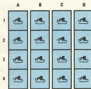
Fig. 9 Una PROM, prima di essere programmata, può schematizzarsi come una tabella in ogni quadretto della quale è presente una condizione logica « 1 », nel nostro esempio una nave. Per programmarla occorre cancellare nei quadretti che ci interessano le navi, come vedesi nella fig. 8, dopodiché la PROM diverrà una ROM.
