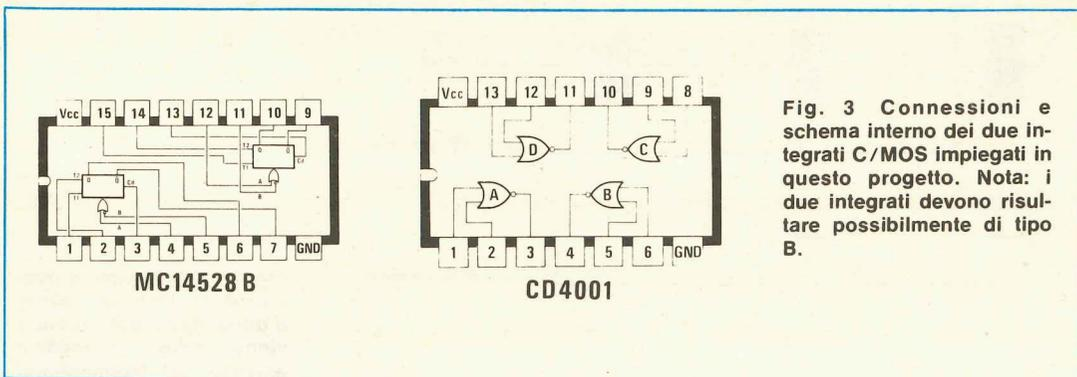
**Fig. 3** Connessioni e schema interno dei due integrati C/MOS impiegati in questo progetto. Nota: i due integrati devono risultare possibilmente di tipo B.
