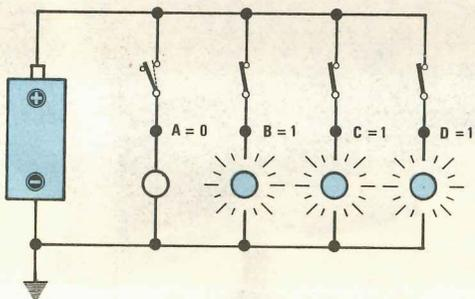
Fig. 2 Se in questo circuito modifichiamo la posizione dei vari interruttori, possiamo a nostro piacimento modificare le condizioni logiche sulle quattro uscite A-B-C-D. In questo esempio noi abbiamo in condizione logica 0 il solo terminale d'uscita A mentre i restanti tre terminali sono in condizione logica 1.
