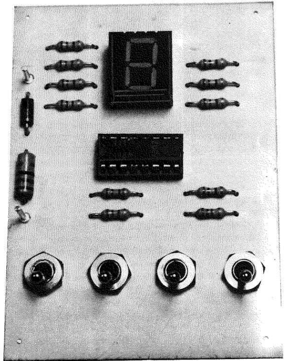
**Fig. 30** Foto del progetto presentato in fig. 4 e 7 che consigliamo di realizzare per poter « familiarizzare » con il codice binario. Si comprenderà come modificando solo quattro ingressi, sia possibile ottenere sui display dieci numeri da 0 a 9.
