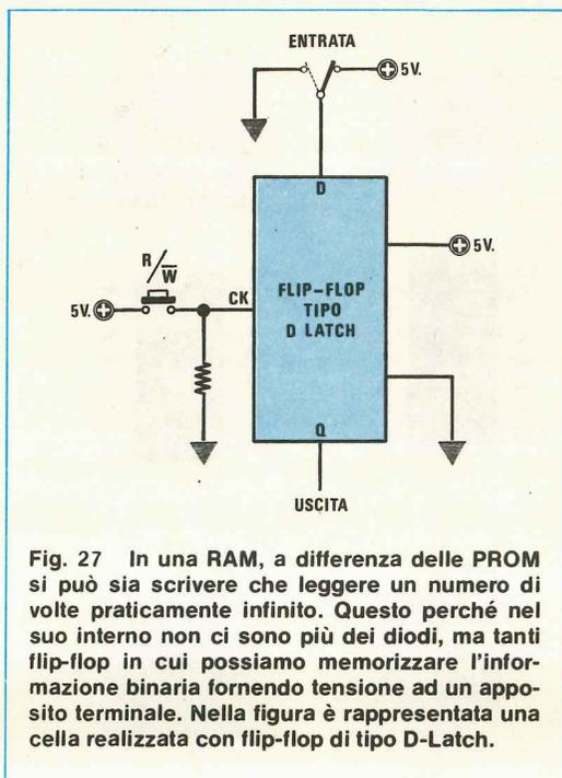
Fig. 27 In una RAM, a differenza delle PROM si può sia scrivere che leggere un numero di volte praticamente infinito. Questo perché nel suo interno non ci sono più dei diodi, ma tanti flip-flop in cui possiamo memorizzare l'informazione binaria fornendo tensione ad un apposito terminale. Nella figura è rappresentata una cella realizzata con flip-flop di tipo D-Latch.
