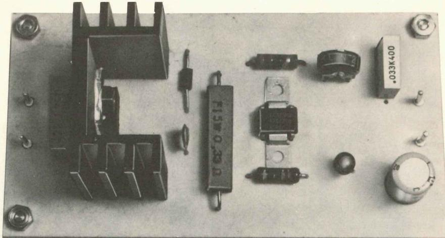
sostituire il darlington TR1 con uno che sia in grado di sopportare fino a 6-8 ampère (per esempio un BD53) e contemporaneamente ridurre il valore della resistenza R4 portandolo per esempio a 0,18 ohm oppure a 0,12 ohm perché altrimenti, lasciando il valore da noi indicato, la protezione interverrà non appena si superano i 2 ampère.
