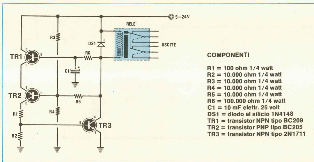
transistor passano in conduzione cosicché la base di TR3 viene a trovarsi polarizzata tramite R1 ed R2 e di conseguenza anche questo transistor inizia a condurre.
