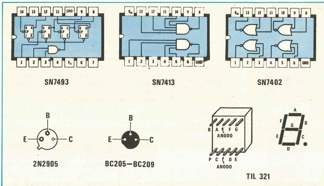
**Fig. 7** Connessioni degli integrati, visti da sopra, dei transistor, visti da sotto e del display, visto da dietro, impiegati in questa slot-machine. Come noterete i display risultano ad anodo comune, quindi non possono essere sostituiti per esempio con degli FND.500 che invece sono a catodo comune.
