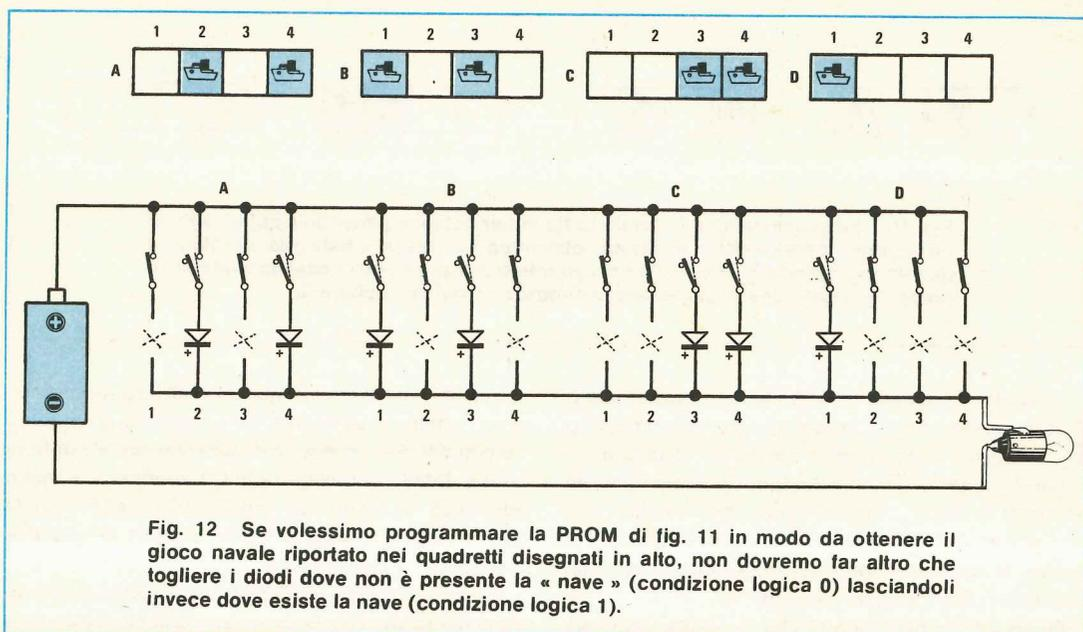
Fig. 12 Se volessimo programmare la PROM di fig. 11 in modo da ottenere il gioco navale riportato nei quadretti disegnati in alto, non dovremo far altro che togliere i diodi dove non è presente la « nave » (condizione logica 0) lasciandoli invece dove esiste la nave (condizione logica 1).
