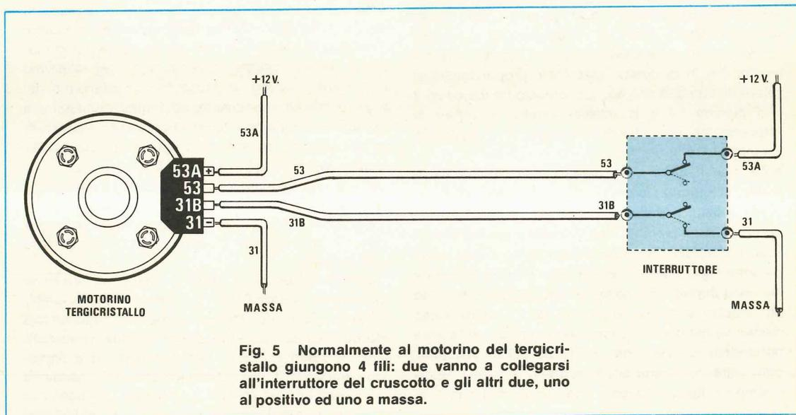
Fig. 5 Normalmente al motorino del tergicristallo giungono 4 fili: due vanno a collegarsi all'interruttore del cruscotto e gli altri due, uno al positivo ed uno a massa.
