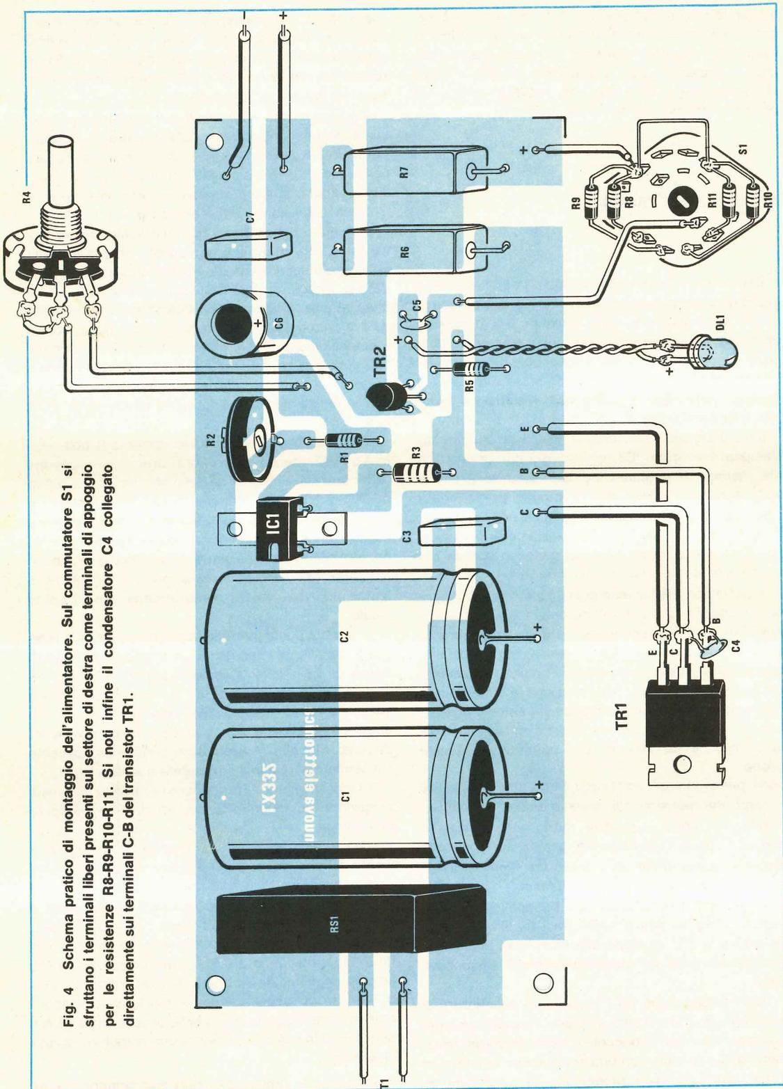
Fig. 4 Schema pratico di montaggio dell'alimentatore. Sul commutatore S1 si sfruttano i terminali liberi presenti sul settore di destra come terminali di appoggio per le resistenze R8-R9-R10-R11. Si noti infine il condensatore C4 collegato direttamente sui terminali C-B del transistor TR1.
