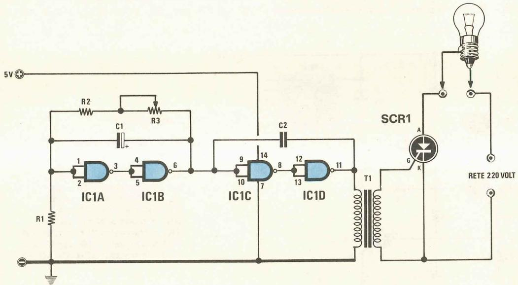
che funziona a 5 volt da quello comprendente l'SCR che funziona invece a tensione di rete, cioè a 220 volt.
